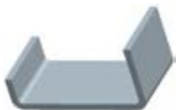
图 11.2.2 拉伸类型的第一钣金壁
