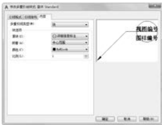
图 9-78 将多重引线类型设为块后的界面
