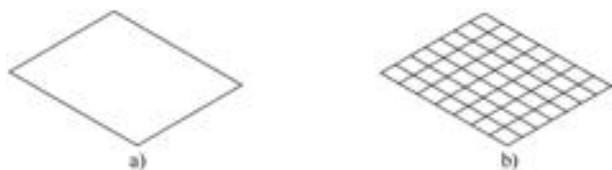
图 11-20 绘制平面曲面 a) 作为草图的矩形 b) 生成的平面曲面
