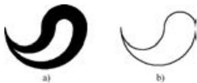
图 2-65 修改整条多段线的线宽 a) 修改前 b) 修改后
