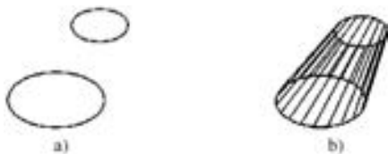
图 11-7 绘制直纹曲面 a) 作为草图的圆 b) 生成的直纹曲面
