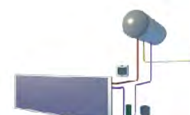
水箱安装在室内
