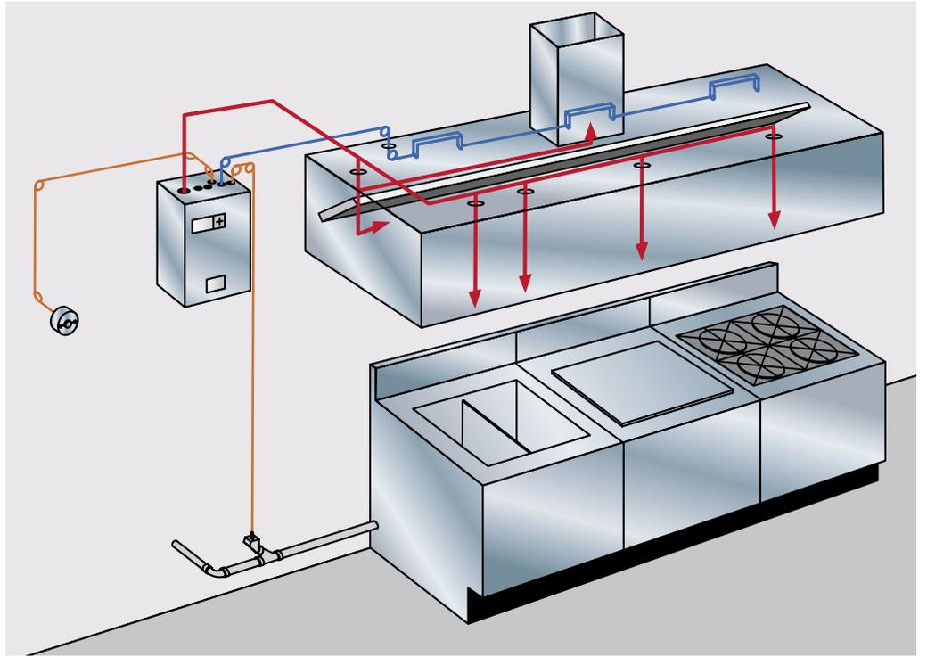
ANSULEX® 液体灭火剂 ■ 采用业经证明的熔线探测和断开系统的两种基本设计
